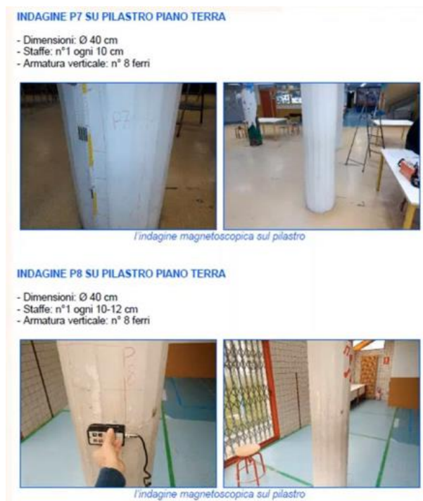
Fig. 10 Scheda 3: Indagini magnetoscopiche eseguite sui pilastri P7 e P8
