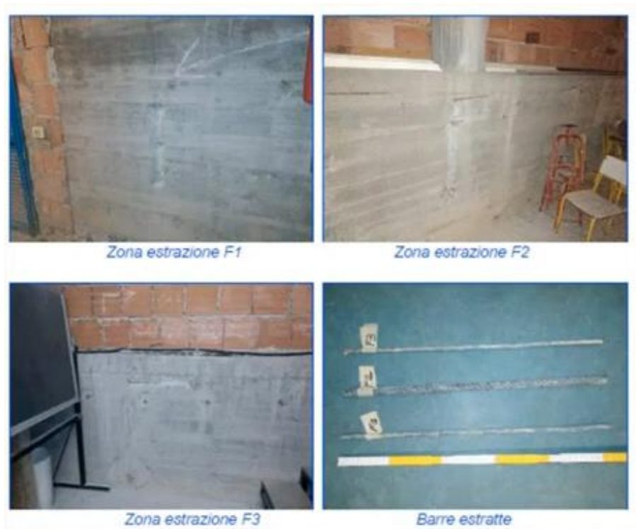
Fig. 11 Scheda 4: Immagini delle zone di estrazione dei campioni delle barre di armatura per c.a.
