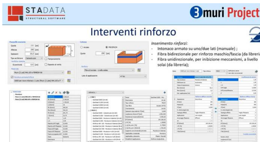
Fig. 7 Software 3Muri Project – finestre di dialogo dedicate all'inserimento degli interventi di rinforzo strutturale negli elementi in muratura portante e nei solai
