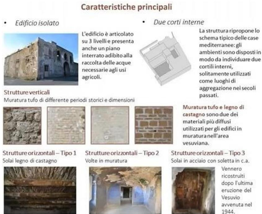
Fig. 6 Panoramica delle caratteristiche principali delle elementi portanti verticali e orizzontali della masseria
