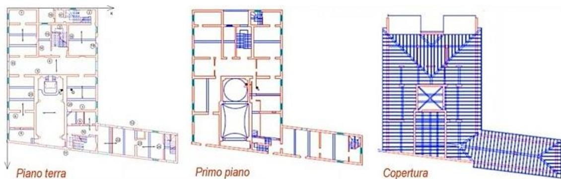
Fig. 14 Planimetria del piano terra e piano primo. Orditura delle travi lignee del tetto a falde
