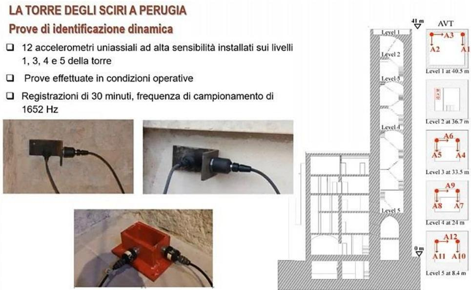
Fig. 22 Accelerometri uniassiali installati su vari livelli della torre per le prove di identificazione dinamica
