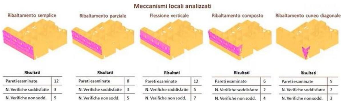
Fig. 8 Meccanismi di ribaltamento delle facciate della Masseria Rossi analizzati in 3Muri Project
