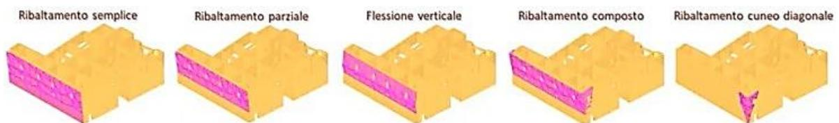
Fig. 3 Meccanismi di ribaltamento di primo modo
