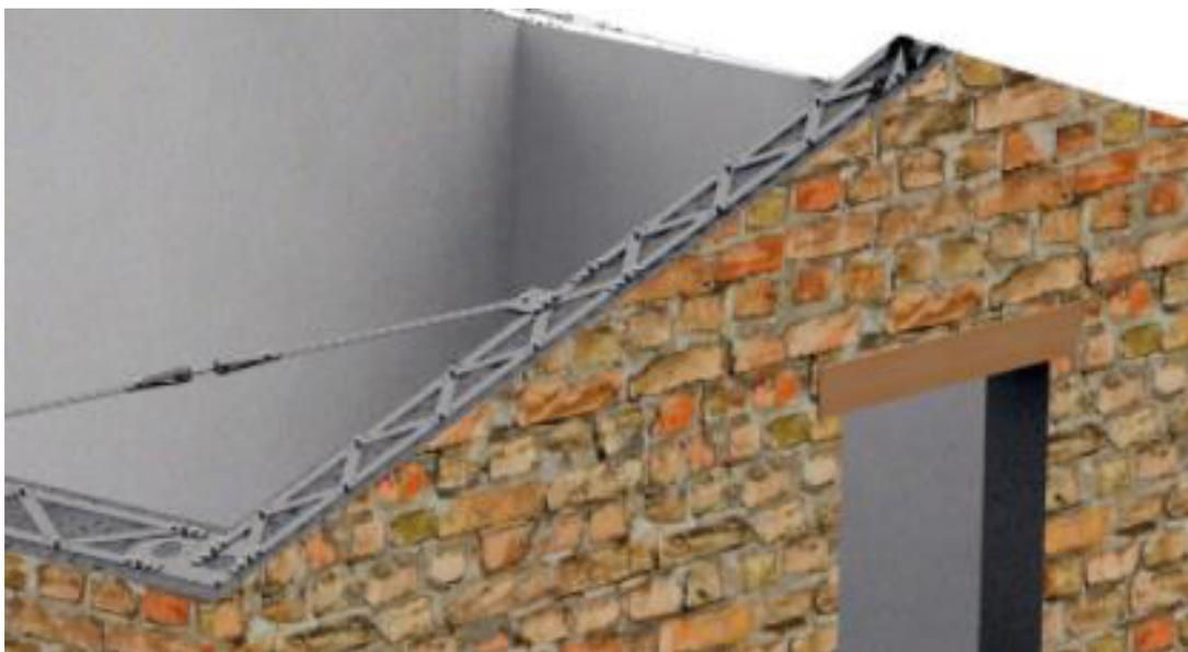
FIGURA 192 - PARTICOLARE CORDOLO TRALICCIATO IN ACCIAIO
