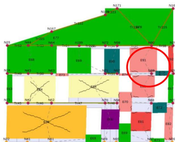
FIGURA 148 - VISUALIZZAZIONE DANNEGGIAMENTO DELLA PARETE 6 AL PASSO 14
