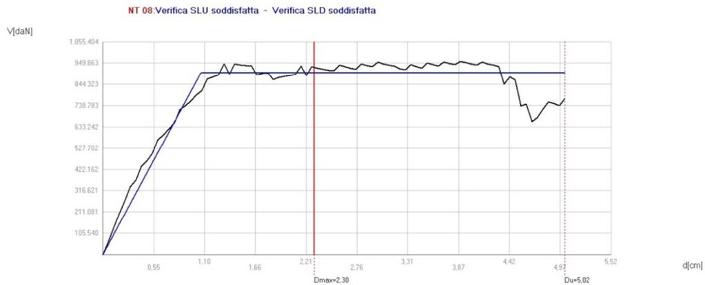
L'analisi 20 viene suddivisa in 86 sottopassi di cui il n. 40 si riferisce, nella curva di capacità, allo spostamento minimo richiesto in normativa  $D_u$ ; nella parete P3 in oggetto, si osserva il seguente stato di danneggiamento così come riportato nella mesh:
