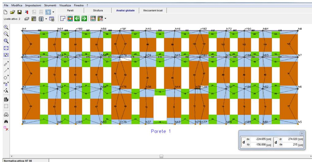
Figura 48 - Ambiente grafico dell'analisi globale e mesh di una parete
