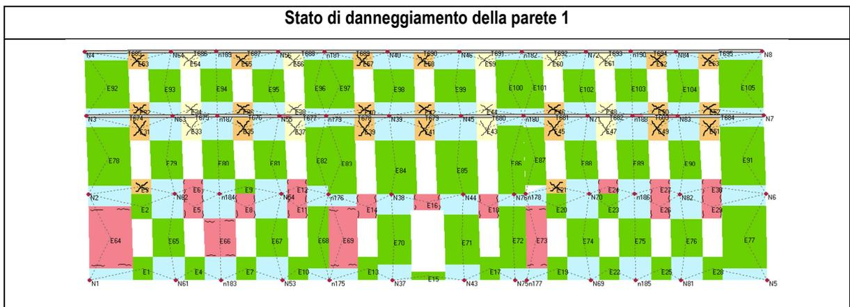
Il meccanismo di collasso, relativo invece all'ultimo passo di carico in cui si raggiunge la crisi in alcune parti dell'edificio, mostra una maggiore percentuale di rottura delle pareti murarie poste nella stessa direzione del sisma, pari a:
