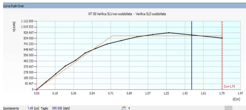
Fig. 5.4. Curva di capacità (taglio alla base-spostamento in sommità) dell'analisi 22, modello 4L
