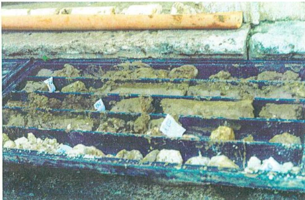
Fig.14 - Struttura del terreno sotto il piano fondale ed in profondità
