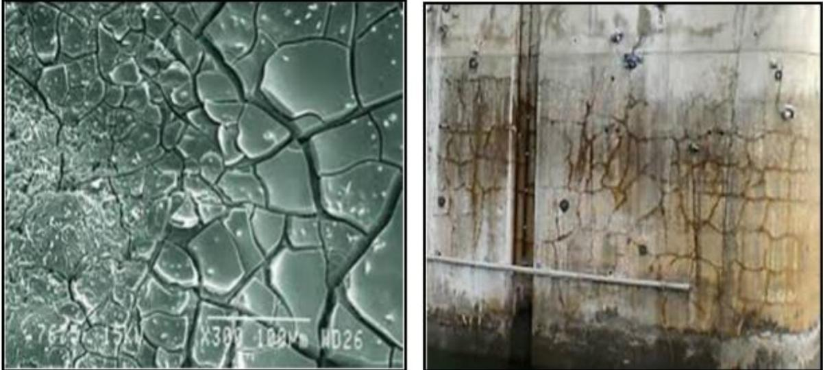
**Figure II.1.** Réactions alcalis-granulats. (Houmeur Mouaadh, 2018)
