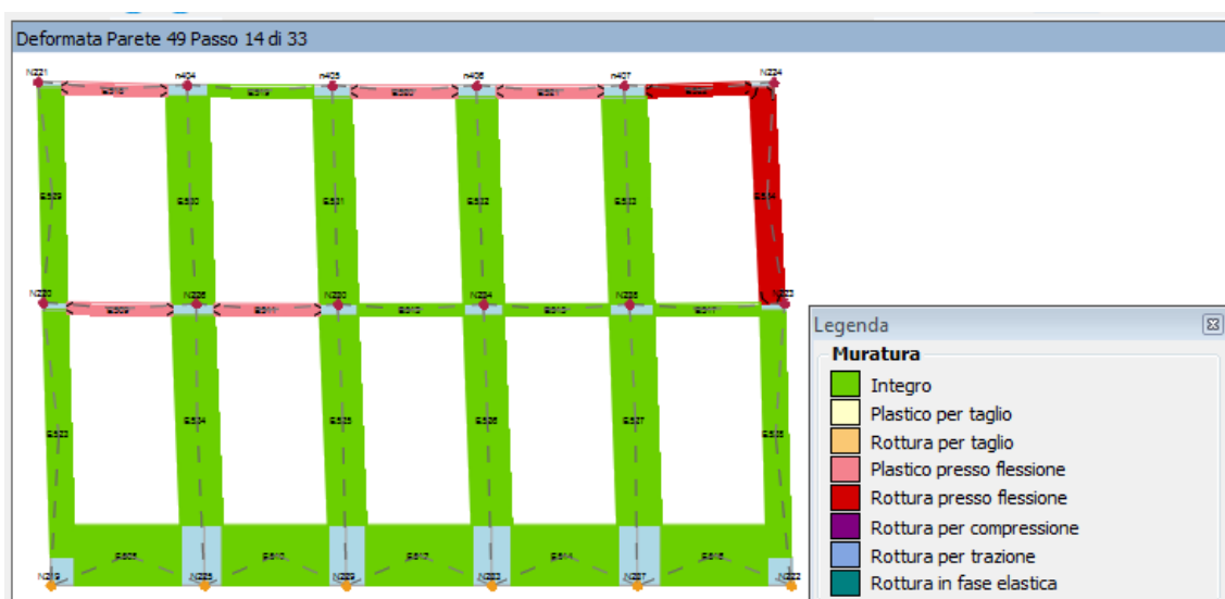
Fig. 4.34. Prospetto deformato e danneggiato relativo alla parete 49 ( passo 14 di 33).
