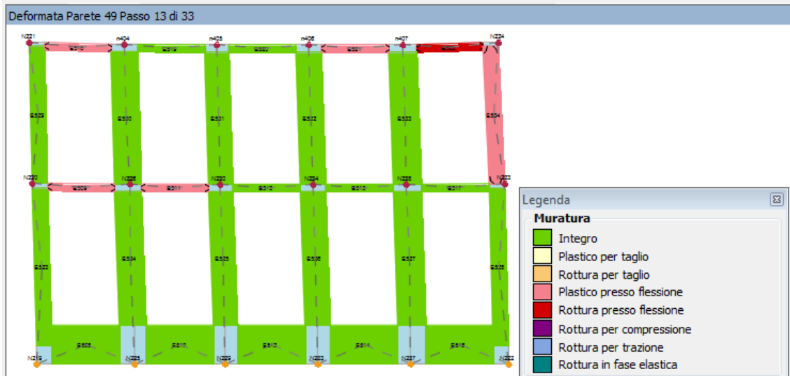
Fig. 4.31. Prospetto deformato e danneggiato relativo alla parete 49( passo 13 di 33).
