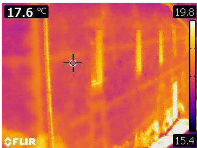
Figura 3-69 - FLIR0316. Immagine termocamera del 24.04.2018. Tessitura muraria della Sala Teatro. Prospetto Est
