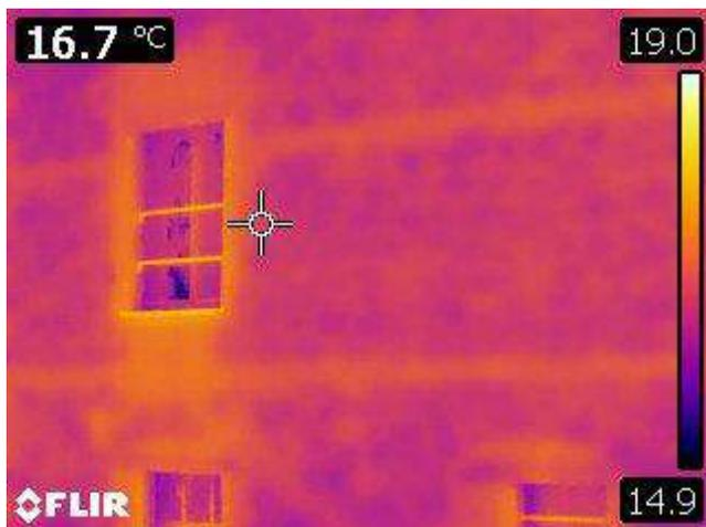
Figura 3-72 - FLIR2396. Immagine termocamera del 24.04.2018. Tessitura muraria della Sala Teatro. Prospetto Ovest
