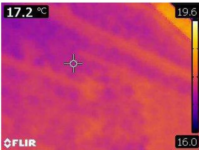
Figura 3-84 - FLIR0290. Immagine termocamera del 24.04.2018. (VN1) Varco murario tamponato 1, Prospetto Nord.
