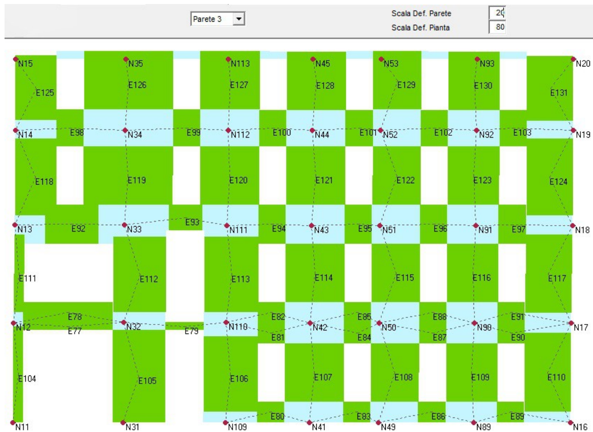
Fig. 6 Modalità di vibrazione della parete fase 20
