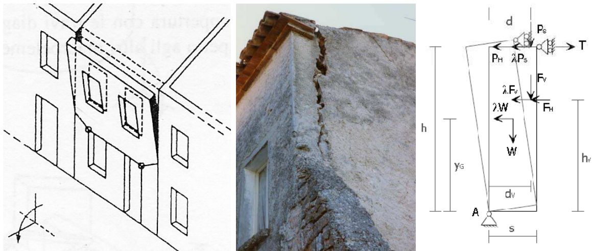
Fig. 8 – Esempio di meccanismo di ribaltamento semplice (meccanismo di 1°Modo fuori dal piano) : scarso ammorsamento nel nodo tra le pareti ortogonali; assenza cordoli in c.a. lungo il profilo delle pareti; presenza di elementi spingenti. (Foto MEDEA, Zuccaro Papa 2003).
