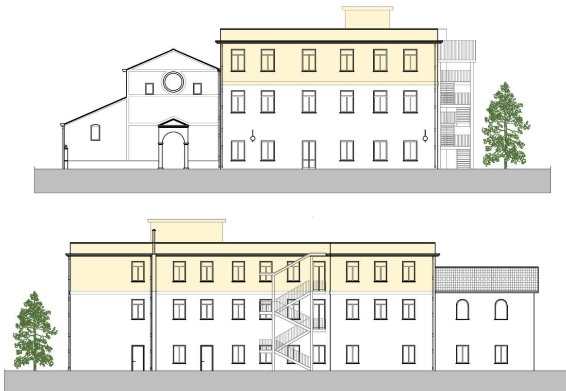
Fig. 57 Individuazione delle fasi costruttive (in giallo il 3°livello a seguito della sopraelevazione). Istituto Scolastico Superiore di primo grado (Scuola Media) - Comune di Sant'Arcangelo (PZ).
