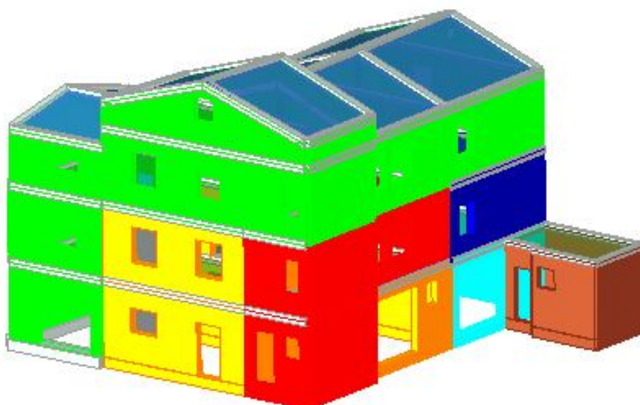
Figura 2.5 Terzo ampliamento (Verde = POROTON 30x20x45).
