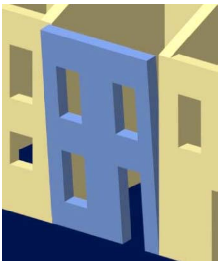
Figura 10 - Ribaltamento dell'intera parete
