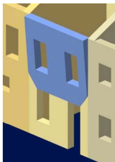
Figura 11 - Ribaltamento dell'ultimo piano della parete
