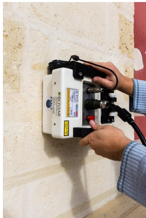
Figura 9.20 - Acquisizione con antenna da 600 Mhz.
