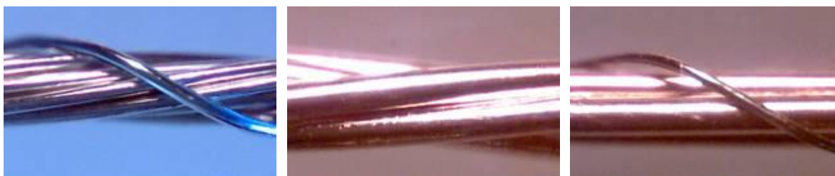
Figura 4.4 - Alcuni esempi delle possibili tipologie di trefolo: le variabili in tal senso sono rappresentate dal numero di fili per trefolo e dalle modalità di intreccio dei fili stessi [13].
