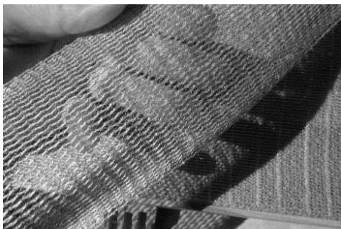
Figura 4.7 - Cavi tenuti insieme da maglie in poliestere e rame [19].
