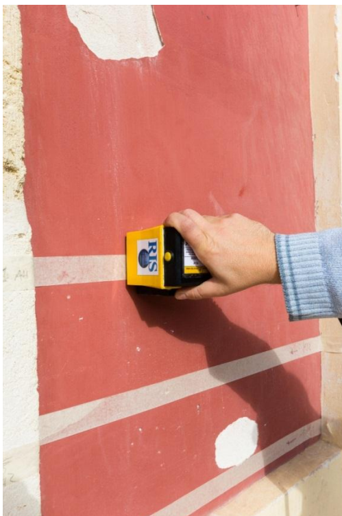
Figura 9.19 - Acquisizione con antenna da 2 Ghz.
