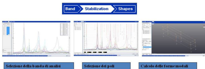
Figura 2.13- Interfaccia grafica delle fasi necessarie all'identificazione dei parametri modali mediante modello LMS Polymax.
