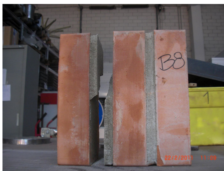
Fig. 4.4.16 - Rottura campione B8
