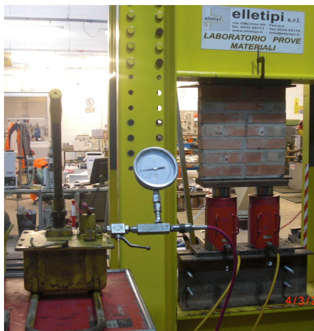
Fig. 4.4.3 – Campione C3 sottoposto a prova di compressione semplice
