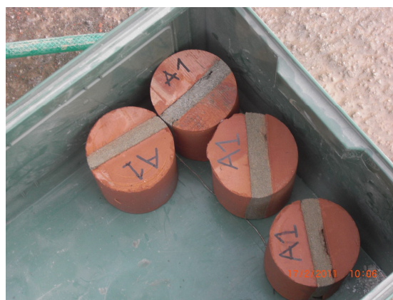
Fig. 4.4.2 – Carote tipo ricavate dai campioni di tipo A
