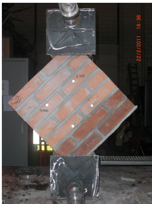
Fig. 4.4.6 – Campione C2 sottoposto a prova di compressione diagonale
