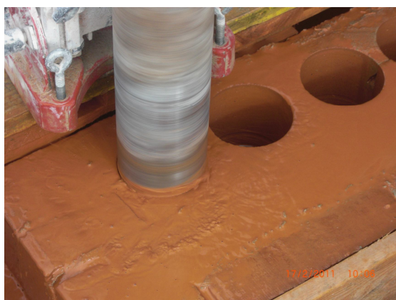
Fig. 4.4.1 – Carotaggio dei muretti
