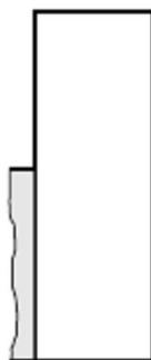
Fig. 4.4.10 – Rottura per taglio nell'area di collegamento malta/mattone
