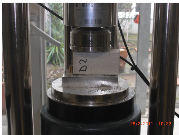
Fig. 4.3.7 – Provino D2 – A sottoposto a prova di compressione
