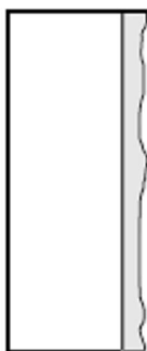
Fig. 4.4.10 – Rottura per taglio nell'area di collegamento malta/mattone
