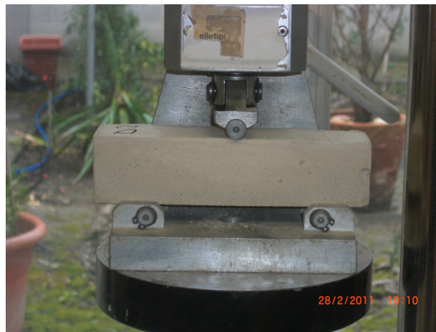
Fig. 4.3.4 – Provino D2 sottoposto a prova di flessione
