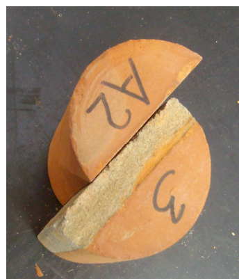
Fig. 4.4.7 – Rottura per slittamento, giunto inclinato a 45°
