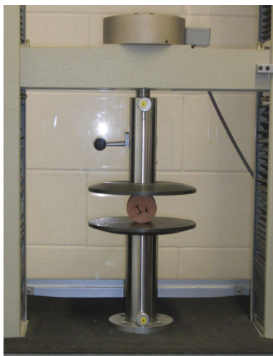
Fig. 4.2.10 – Provino II sottoposto a prova di trazione indiretta
