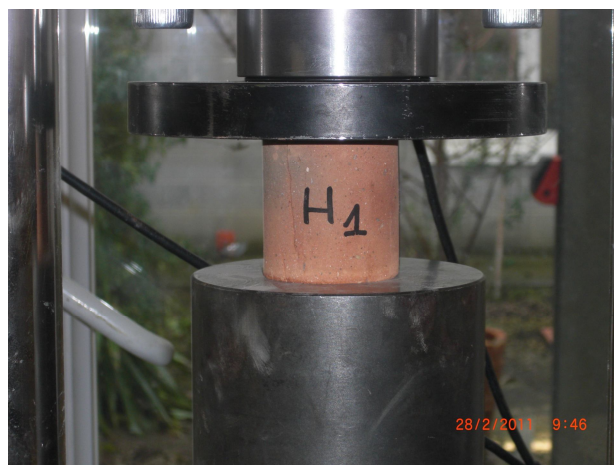
Fig. 4.2.7 – Provino H1 sottoposto a prova di compressione
