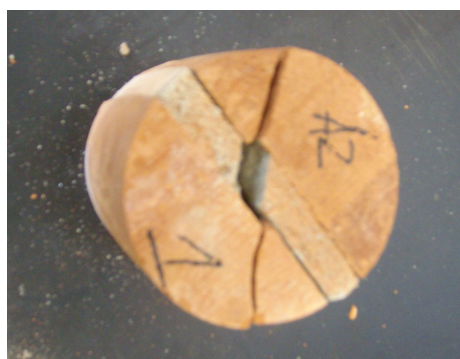
Fig. 4.4.6 – Rottura per trazione, giunto inclinato a 45°
