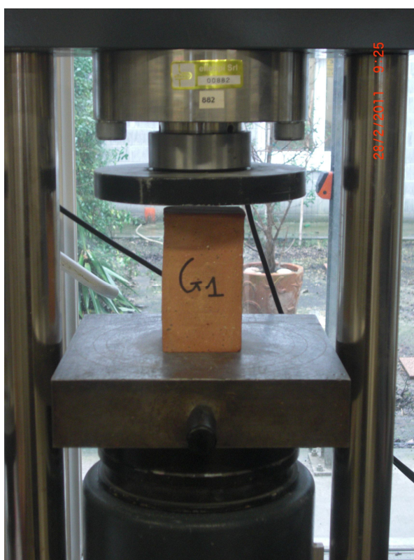
Fig. 4.2.4– Attrezzatura di prova e campione G1
