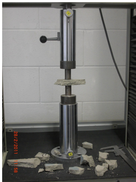
Fig. 4.3.9 – Prova di punzonamento sulla malta
