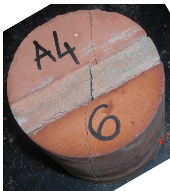
Fig. 4.4.11 – Rottura per trazione, giunto inclinato a 30°
