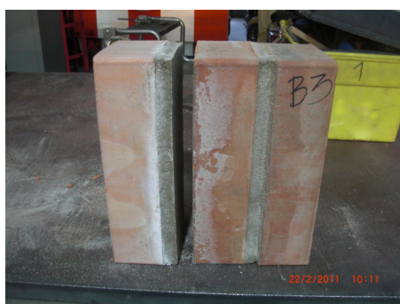
Fig. 4.4.15 - Rottura campione B3
