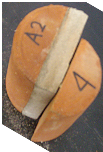
Fig. 4.4.9 – Rottura per slittamento, giunto inclinato a 60°
