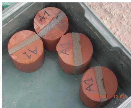
Fig. 4.1.8 – Carote prelevate da un campione tipo A
