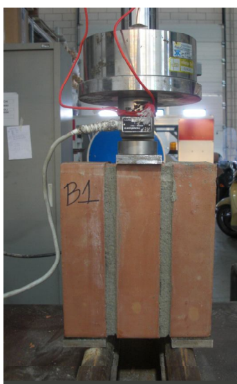
Fig. 4.4.14 – Campione B1 sottoposto a prova di taglio
