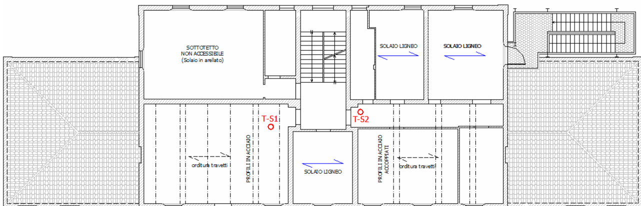
Fig. 2.2.28: Orizzontamento tra Piano Secondo e Sottotetto
