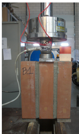
Fig. 3.2.4 – Campione sottoposto a prova di taglio
