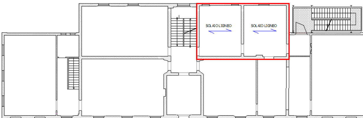
Fig. 9.5.2: Orizzontamento tra P.I e P.II – solaio ligneo oggetto dell'intervento
