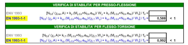
Confrontando quest'ultimo caso con quello della norma NTC 2008 si nota la convergenza dei risultati delle verifiche e le differenze sono dovute ad una diversa valutazione del momento critico elastico che, secondo la norma EN 1993-1-1, per le stesse condizioni di vincolo utilizzate nella NTC 2008, è dato dalla seguente espressione ricavata dall'appendice F della norma sperimentale ENV 1993-1-1:
