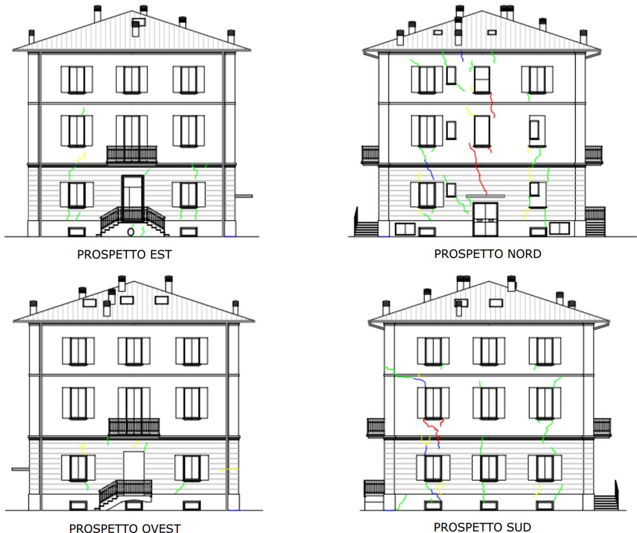
**Figura 2.10:** Rappresentazione del quadro fessurativo - Legenda: cavillature in giallo, fessure lievi in verde, gravi in blu, passanti in rosso
