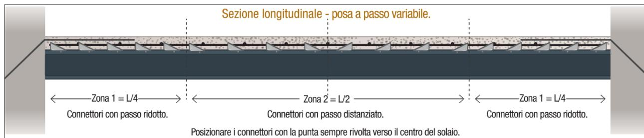
**Figura 4.34:** Sezione longitudinale del solaio rinforzato con posa a passo variabile dei connettori CentroStorico [2]
