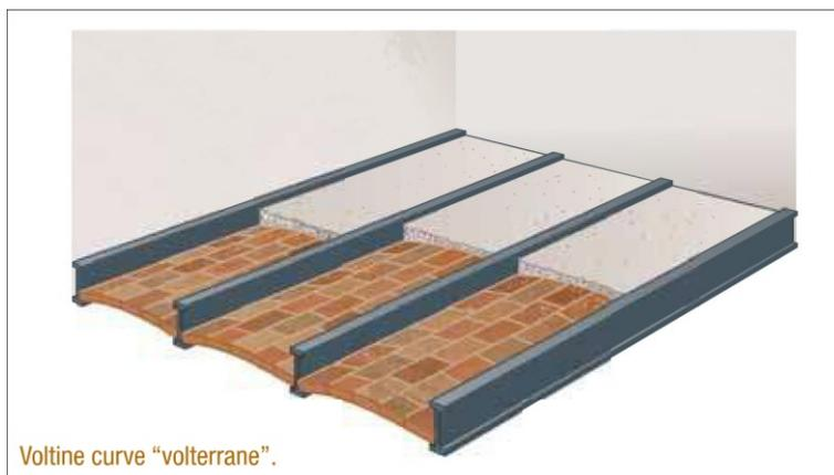
**Figura 2.6:** Solaio in putrelle di ferro e voltine di mattoni pieni disposti in foglio [2]
