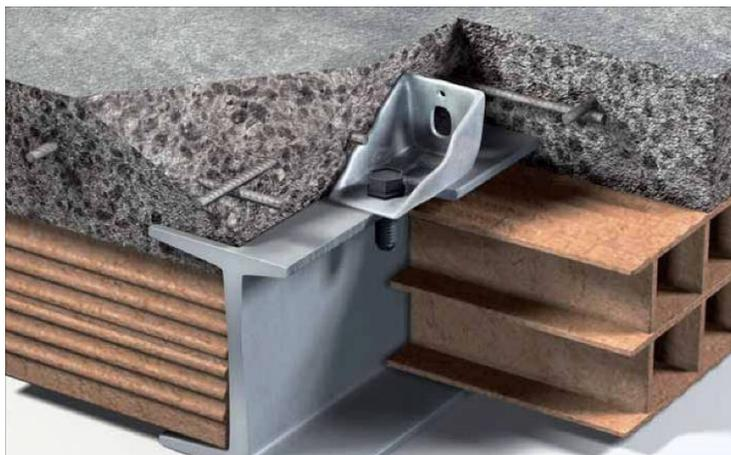
**Figura 4.33:** Dettaglio costruttivo dei connettori metallici CentroStorico che garantiscono la collaborazione tra la trave d'acciaio e la soletta in c.a. [2]
