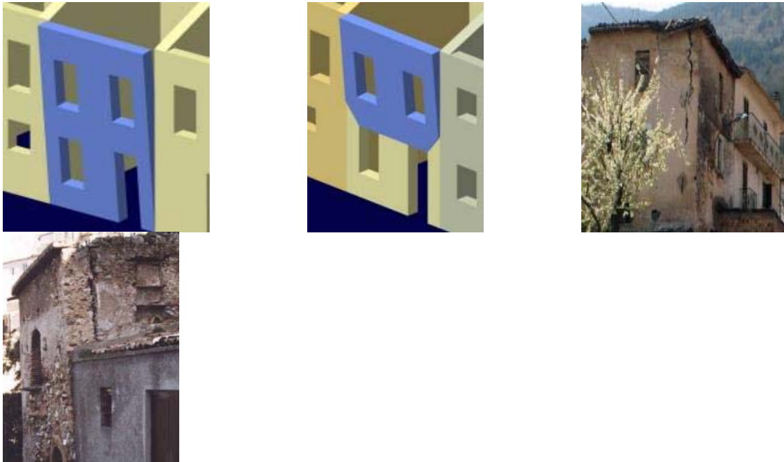
Fig. 2.6 Meccanismo di ribaltamento semplice di parete o di una sua porzione
