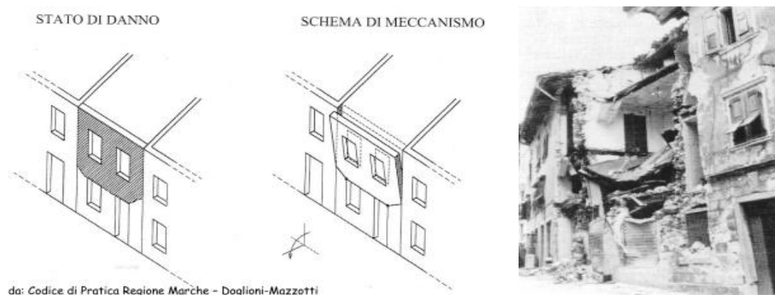
Fig. 4.10 Meccanismo di danno per la parete esterna
