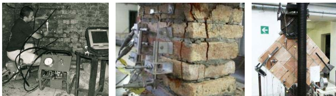
Fig. 4.8 Prove semidistruttive ( prova con martinetto piatto ) e distruttive ( prove di compressione e taglio )
