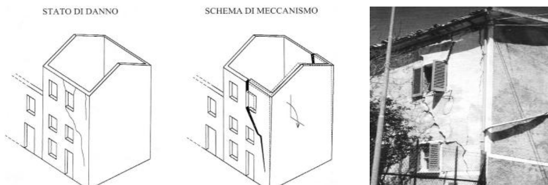
Fig. 4.11 Meccanismo di danno per la parete di testata
