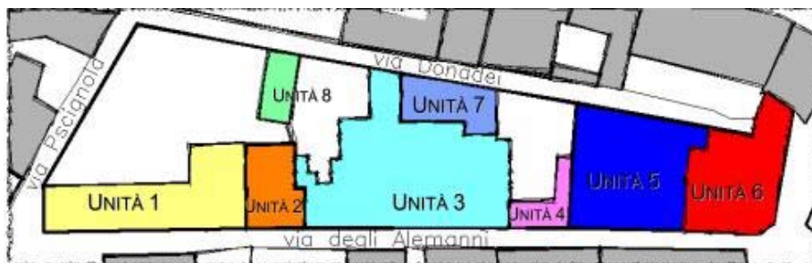
Fig. 4.3 Esempio di identificazione delle unità strutturali
