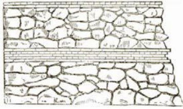
Figura 8 - Filari di laterizi disposti orizzontalmente
