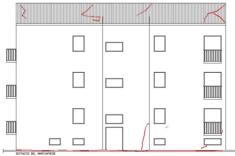
Figura 4-4. Danni prospetto Sud-Ovest
