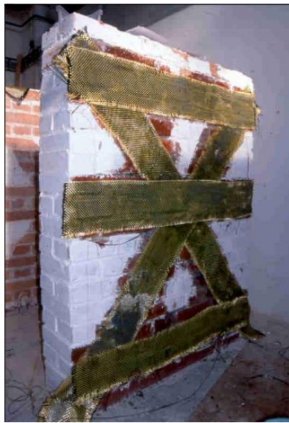
Figura 4-22. Esempio di rinforzo con FRP
