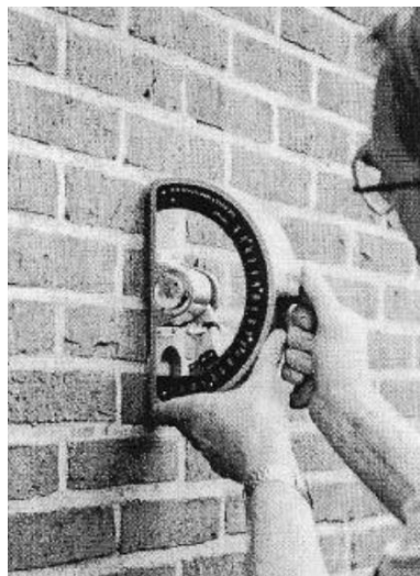
Figura 2-10 .Pendolo per la misurazione della qualità della malta
