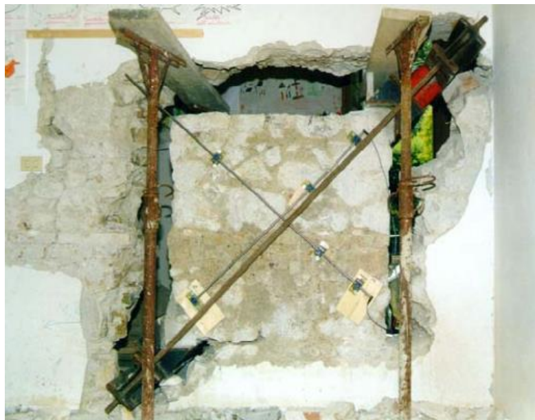
Figura 2-17. Prova di compressione diagonale in situ
