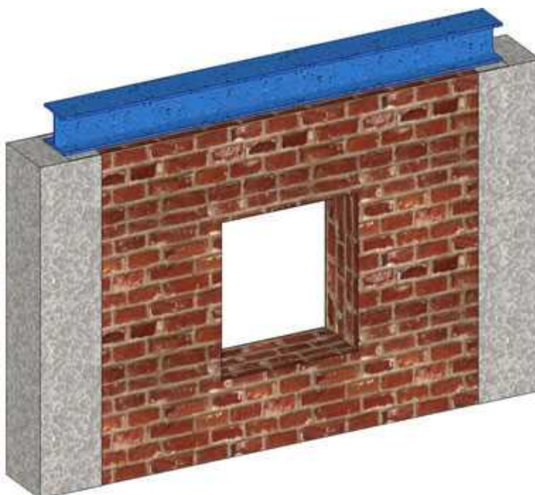
Pannello murario con elementi verticali in c.a. ed elemento trasversale in acciaio
