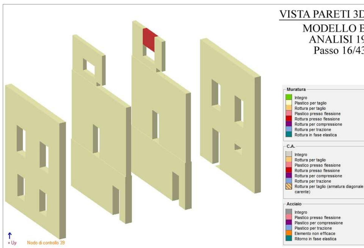
Figura 6.71: analisi 19 passo di carico 16/43 visualizzazione 3D del primo collasso
