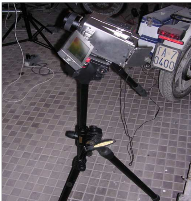
Figura 6.10: Posizionamento termocamera per acquisizione dati
