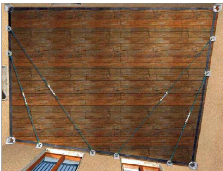
Figura 5.16: Consolidamento solaio ligneo con tiranti metallici
