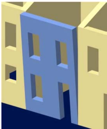
Figura 41 - Ribaltamento dell'intera parete
