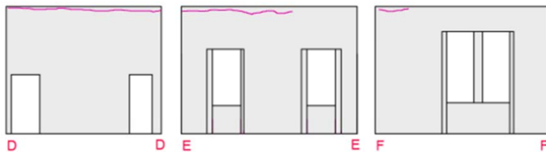
Figura 4.4-19: Schematizzazione delle pareti fessurate nell'ufficio del sindaco (piano primo, angolo a nord ovest).
