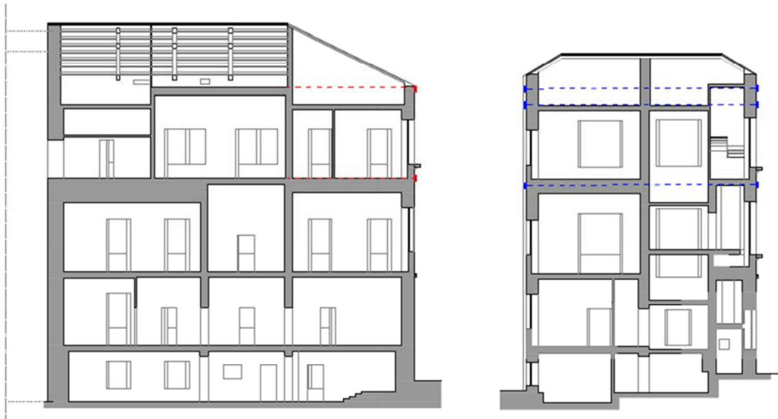
Figura 6.2-4: Schematizzazione della posizione dei tiranti in sezione A-A e D-D, LC1.
