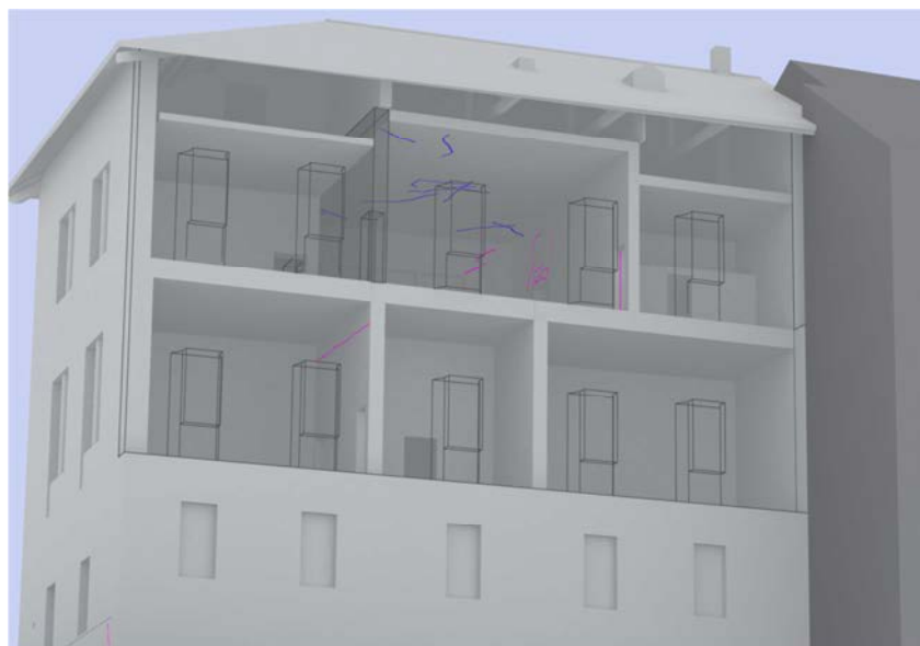
Figura 4.4-20: Individuazione nel modello tridimensionale di alcune fessure nel soffitto e nella parete R-R del piano secondo e nella parete D-D del piano primo.
