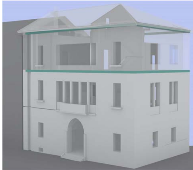
Figura 4.4-7: Vulnerabilità incerta rappresentata da due cerchiature in cemento armato.
