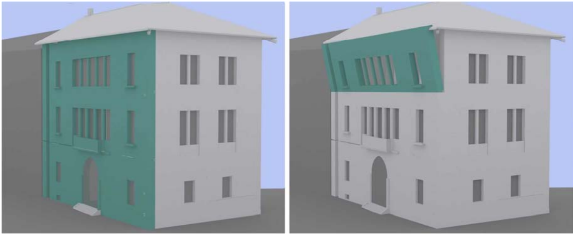
Figura 5.3-29: Individuazione tridimensionale del meccanismo 2 nel macroelemento 4 (A9).
