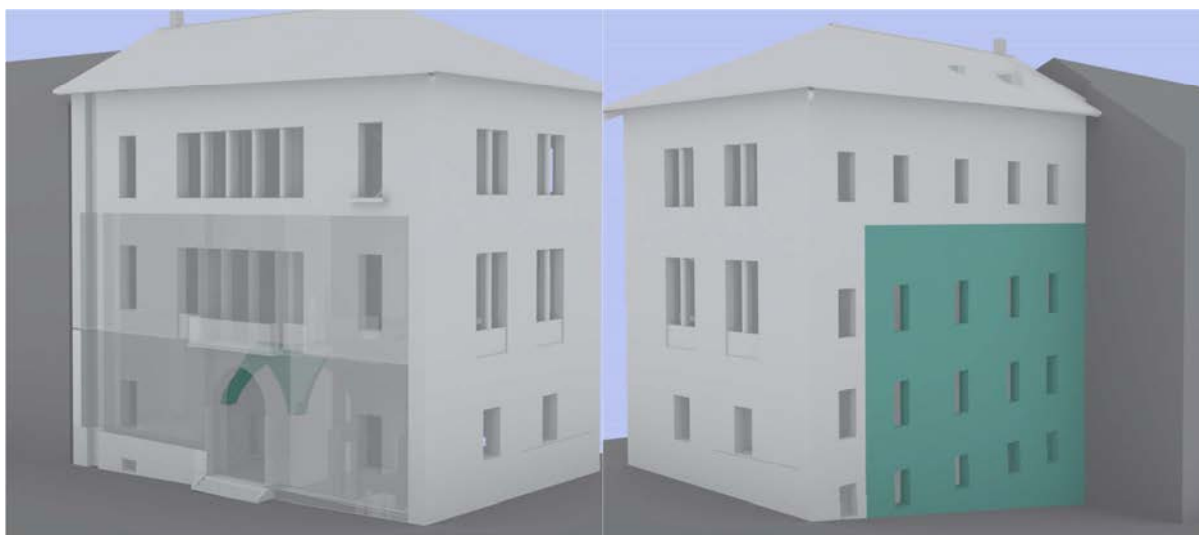
Figura 4.4-6: Vulnerabilità incerte, in verde è evidenziata la volta all'ingresso.
