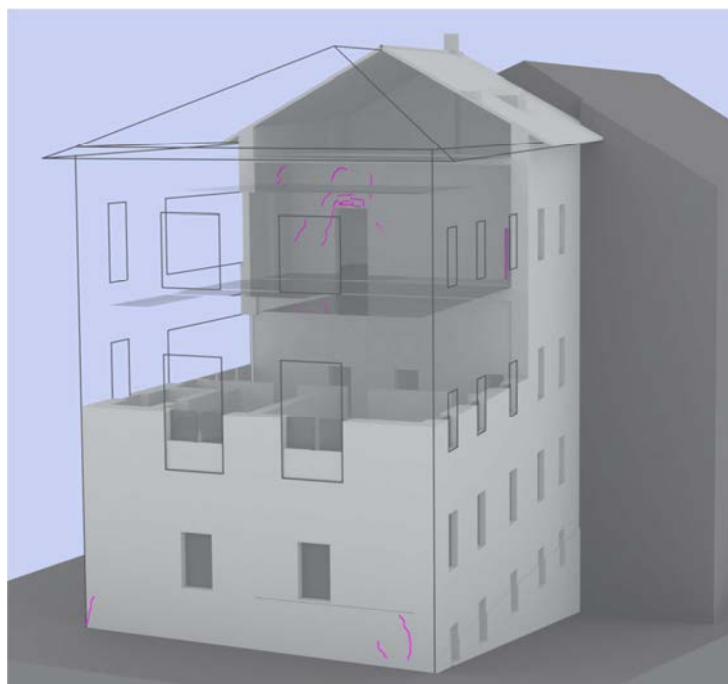
Figura 4.4-16: Individuazione nel modello tridimensionale di alcune fessure al piano secondo, parete R-R.
