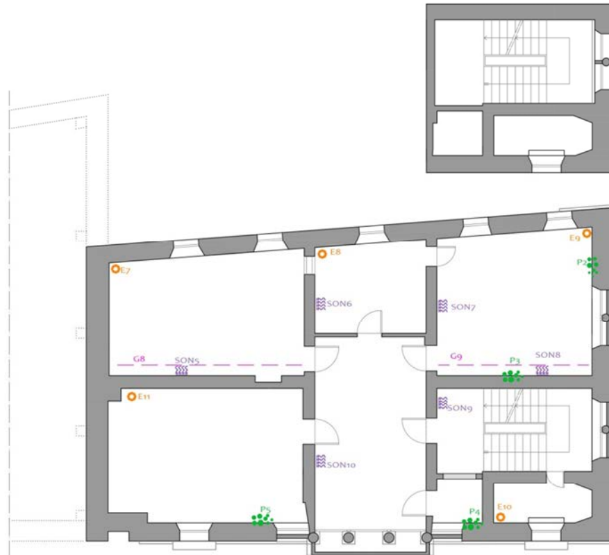
Figura 7.3-4: Proposta di indagini, pianta piano primo.
