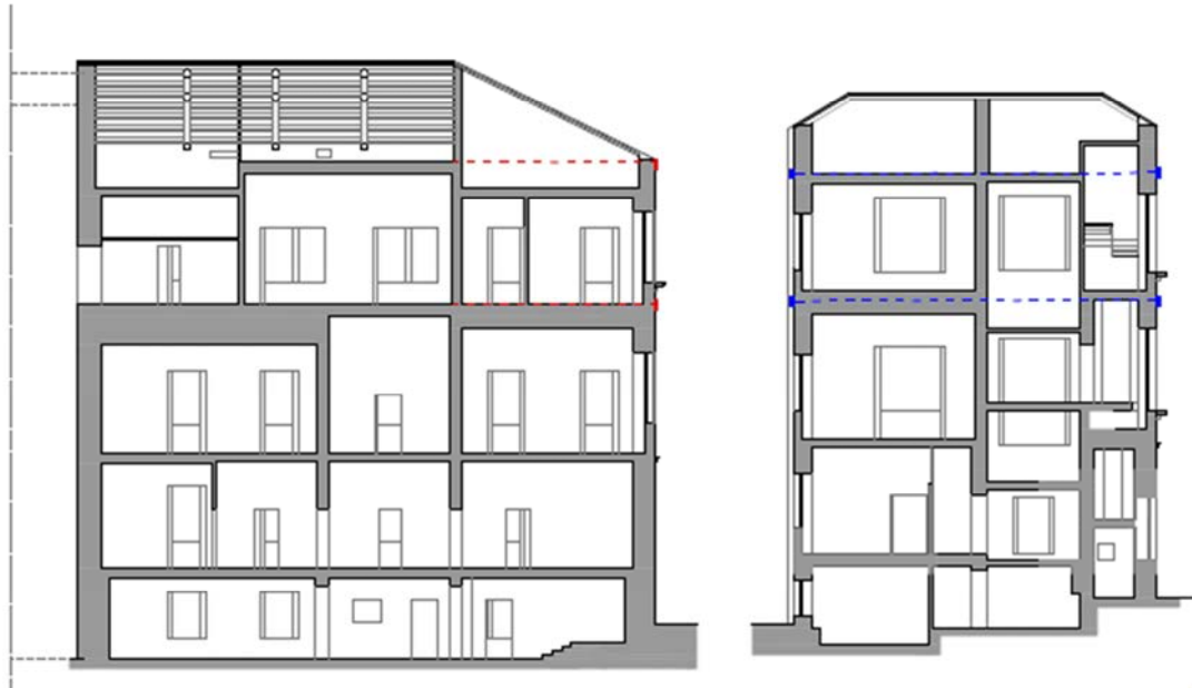
Figura 6.2-7: Schematizzazione della posizione dei tiranti in sezione A-A e D-D, LC2.
