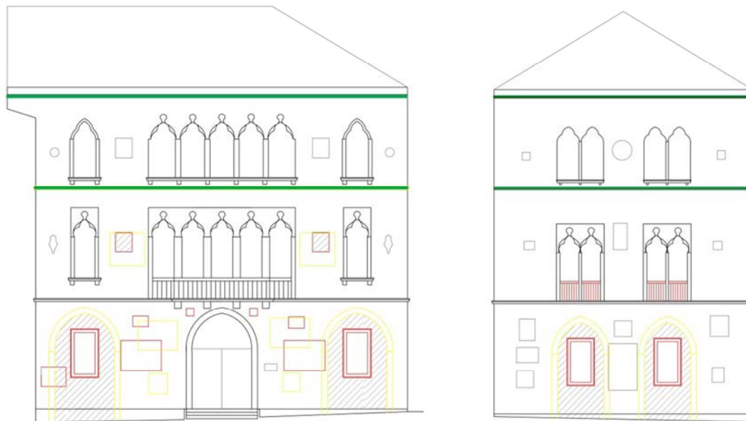
Figura 4.1-3: Rappresentazione degli interventi del 1930 sulle facciate principali, in verde sono indicate le due cerchiature, in giallo le parti demolite e in rosso quelle ricostruite; le porzioni consistenti di muratura costruite ex novo sono evidenziate con retino diagonale.
