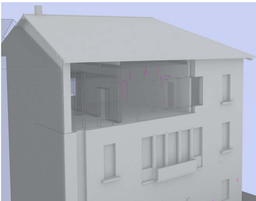
Figura 4.4-15: Individuazione nel modello tridimensionale di alcune fessure al piano secondo, parete P-P.
