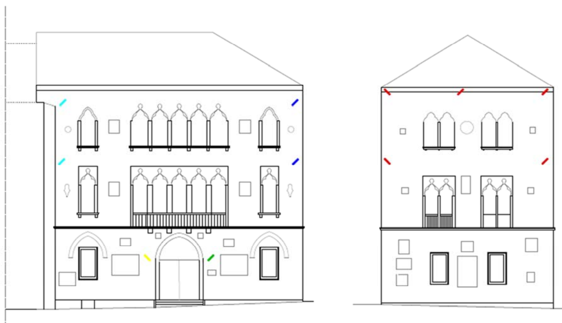
Figura 6.2-6: Schematizzazione della posizione dei capochiave nei prospetti nord-est e nord-ovest, LC2.
