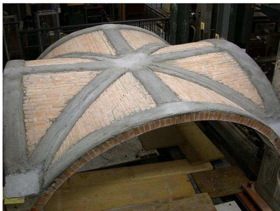
**Figura 7.6.5.2** –Rinforzo materiali compositi – volta a crociera.
