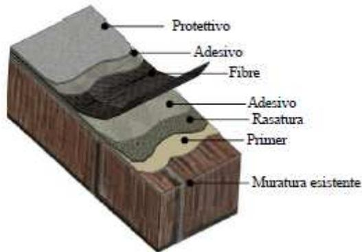
**Figura 7.6.5.4** –Particolare rinforzo strutturale estradossale con materiali compositi.
