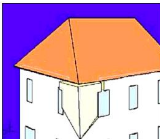
Figura I.40 : Ribaltamento della parte alta del cantonale
