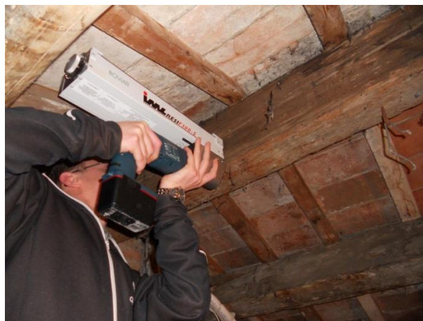
Figura III.26: Indagini eseguite con il Resistograph
