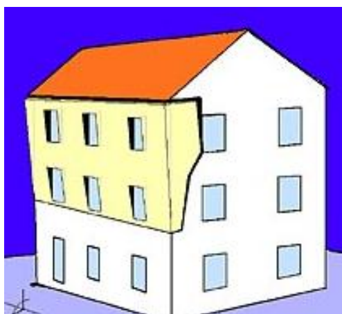
Figura I.11 : Ribaltamento dell'intera parete
