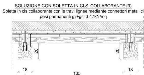
Figura: sezione tecnologica del solaio con soletta in cls collaborante con trave
