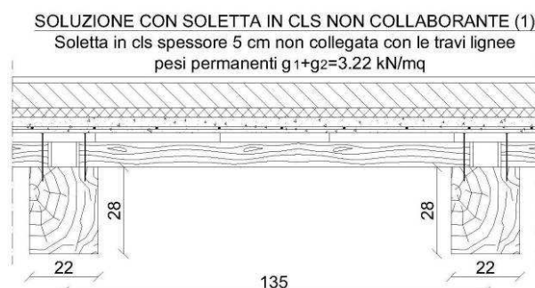
Figura: sezione tecnologica del solaio con soletta in cls NON collaborante con trave
