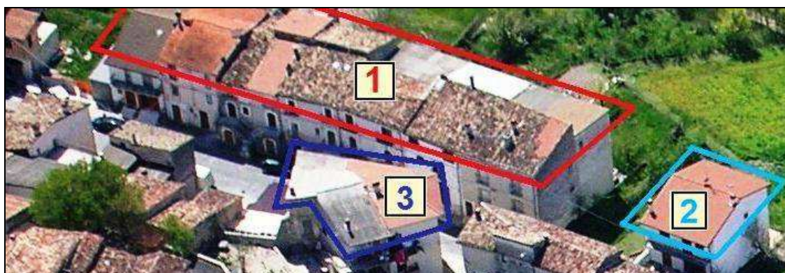
Figura: esempi delle tre tipologie di aggregazione delle unità strutturali: 1) U.S. in schiera 2) U.S. singola 3) U.S. in aggregato articolato
