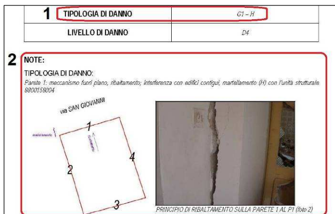
Figura: Stralcio di una scheda di una US: assegnazione della tipologia di danno (1); nota con planimetria del danno individuato (2)
