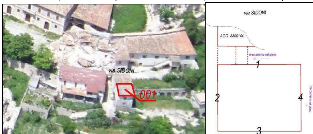
Figure: Foto aerea con l'inquadramento dell'US e planimetria della tipologia dei danni rilevati
