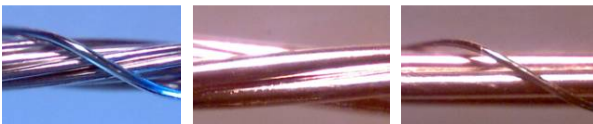
Fig. 6.7 Alcuni esempi delle possibili tipologie di trefolo: le variabili in tal senso sono rappresentate dal numero di fili per trefolo e dalle modalità di intreccio dei fili stessi.
