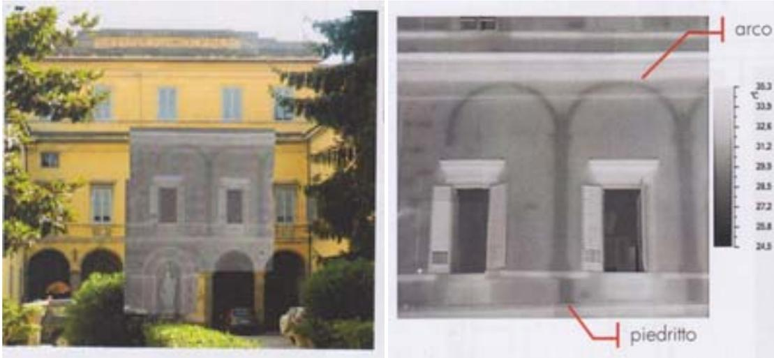
**Figura 3.78** – Termografia sul prospetto Nord e zoom del loggiato al piano primo.
