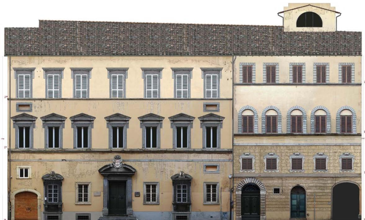
**Figura 3.10** – Restituzione con foto inserimenti del prospetto sud in Via San Martino (vedi tavole allegate).
