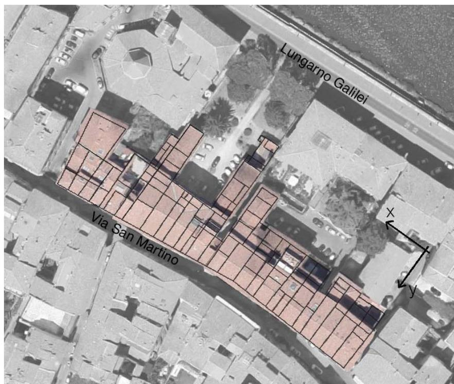
**Figura 6.13**– Porzione di aggregato considerata e relativa schematizzazione delle pareti.
