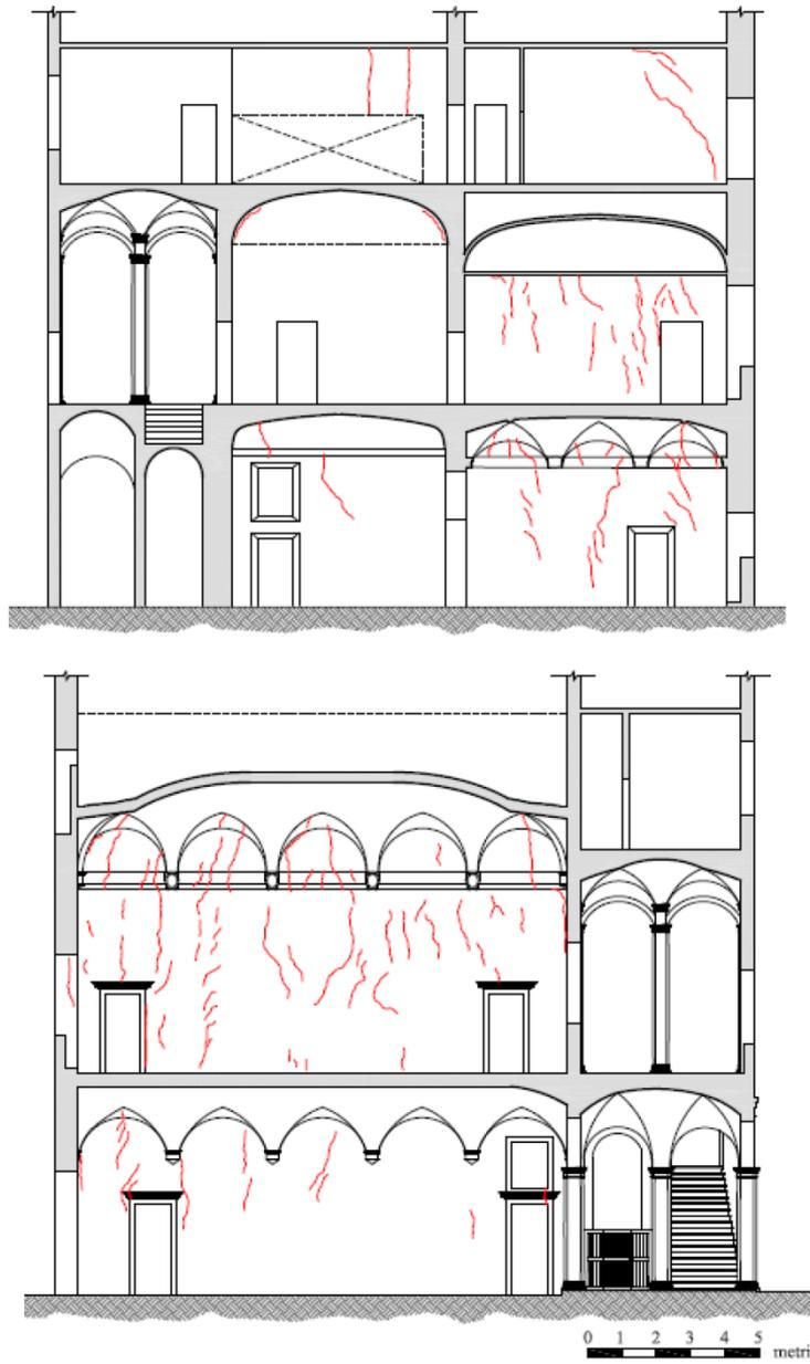
Figura 4.11 – Quadro fessurativo parete 7, scala 1:200. Vista ovest e vista est.
