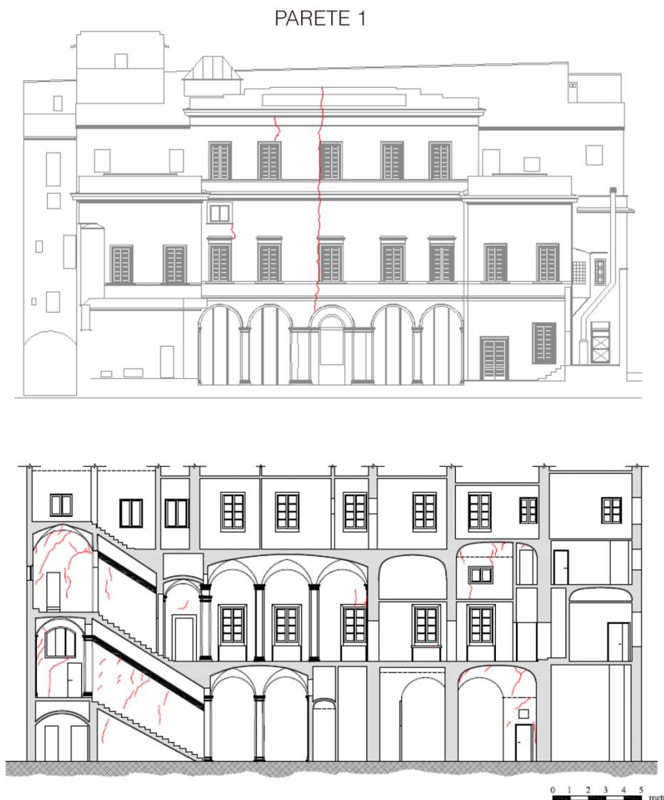
**Figura 4.5** – Quadro fessurativo parete 1, scala 1:200. Vista (prospetto) nord e vista sud.
