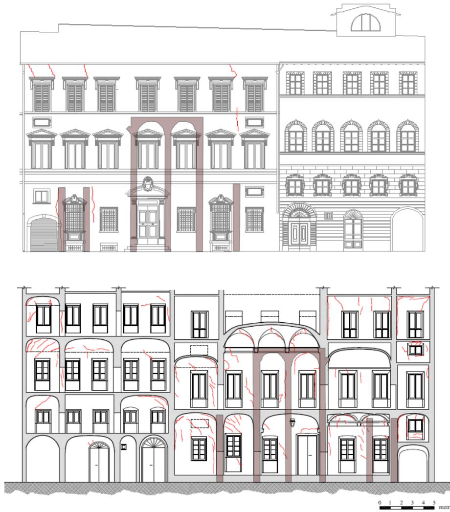
Figura 4.6 – Quadro fessurativo parete 2, scala 1:200, con indicazione dei piedritti medievali. Vista (prospetto) sud e vista nord.
