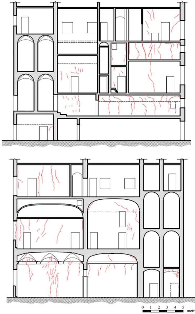
Figura 4.12 – Quadro fessurativo parete 8, scala 1:200. Vista ovest e vista est.
