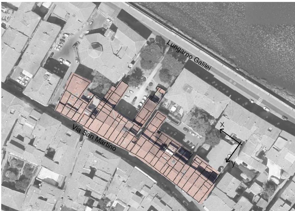
**Figura 8.7** – Individuazioni dello schema delle pareti portanti e delle direzioni considerate per l'analisi pushover.
