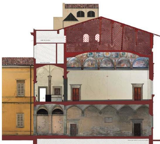
**Figura 8.4**– Meccanismo di collasso relativo alla accelerazione di attivazione minima per la facciata su Via San Martino.
