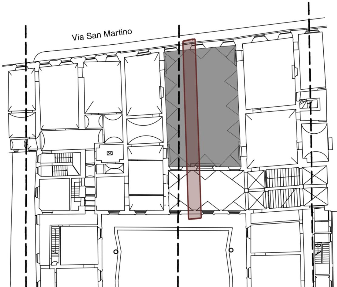
**Figura 3.65** – Al piano primo il muro non prosegue e abbiamo invece la presenza dell’ampio salone.
