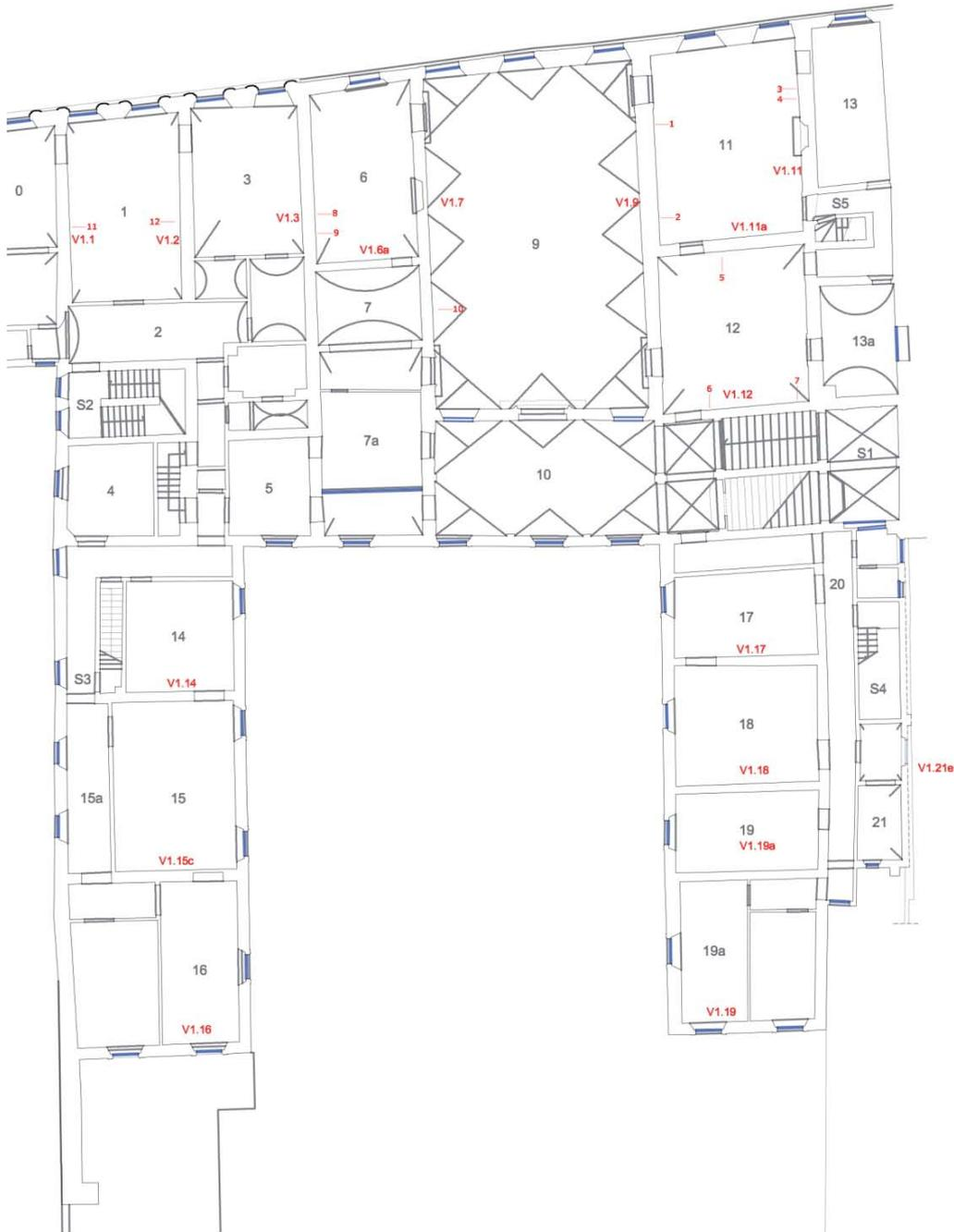
**Figura 4.41** – Planimetria del primo piano con indicazione dei saggi murari.
