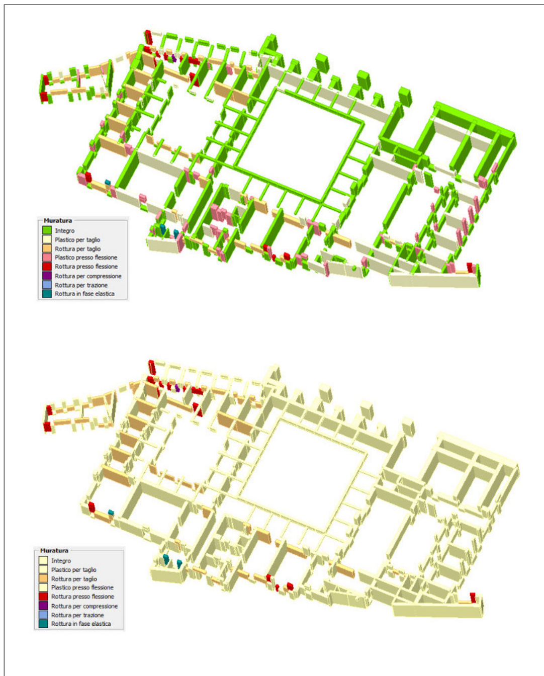
Figura 7.33: Analisi n.3. Piano terra: vista 3D del tipo di danno per sisma in direzione -X . Nell'immagine in alto sono visibili tutti gli elementi, colorati in base al danno; nell'immagine in basso sono più evidenti gli elementi rotti.
