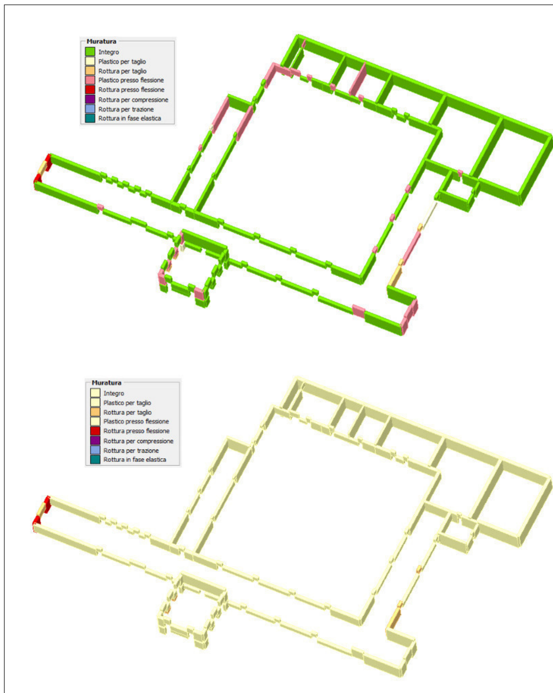
Figura 7.40: Analisi n.18. Piano terzo: vista 3D del tipo di danno per sisma in direzione +Y. Nell'immagine in alto sono visibili tutti gli elementi, colorati in base al danno; nell'immagine in basso sono più evidenti gli elementi rotti.
