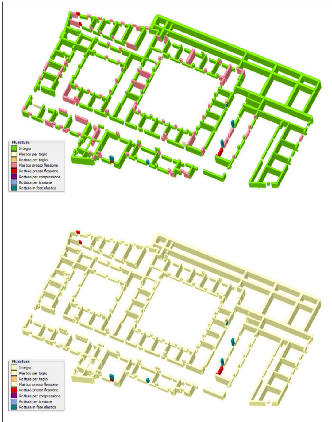
Figura 7.35: Analisi n.3. Piano secondo: vista 3D del tipo di danno per sisma in direzione -X . Nell'immagine in alto sono visibili tutti gli elementi, colorati in base al danno; nell'immagine in basso sono più evidenti gli elementi rotti.
