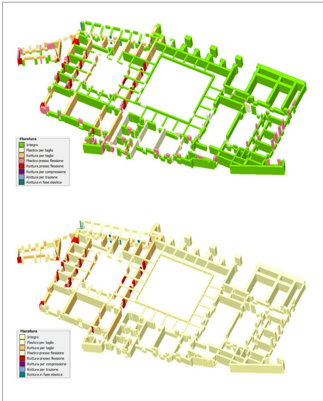
Figura 7.37: Analisi n.18. Piano terra: vista 3D del tipo di danno per sisma in direzione +Y. Nell'immagine in alto sono visibili tutti gli elementi, colorati in base al danno; nell'immagine in basso sono più evidenti gli elementi rotti.
