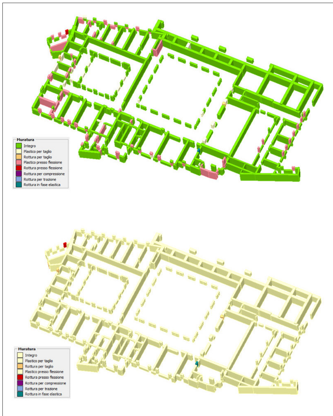
Figura 7.38: Analisi n.18. Piano primo: vista 3D del tipo di danno per sisma in direzione +Y. Nell'immagine in alto sono visibili tutti gli elementi, colorati in base al danno; nell'immagine in basso sono più evidenti gli elementi rotti.
