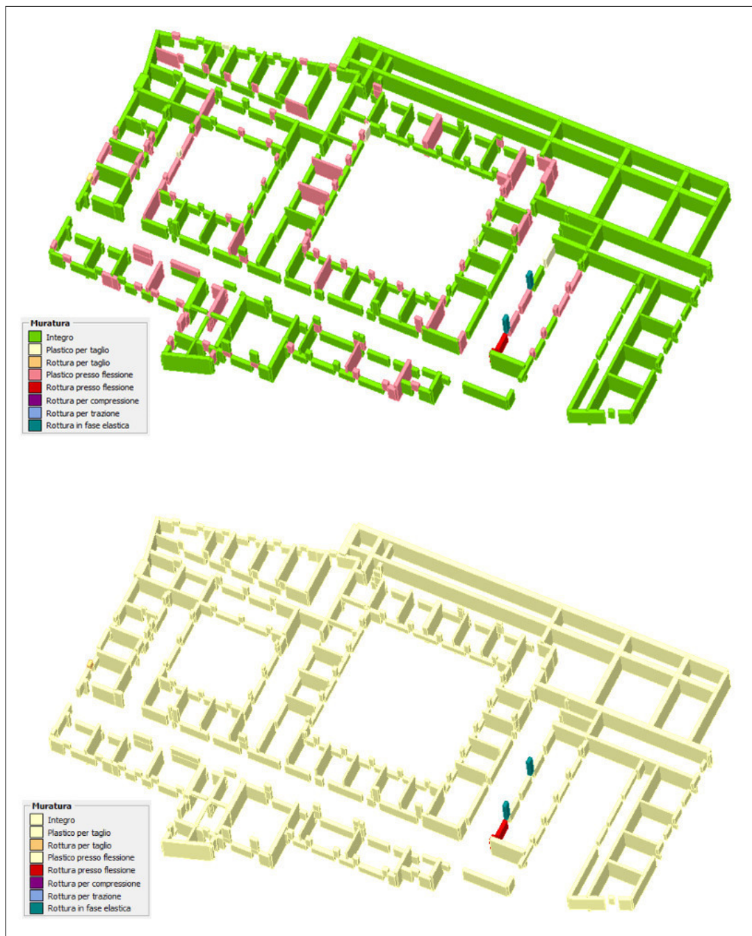
Figura 7.39: Analisi n.18. Piano secondo: vista 3D del tipo di danno per sisma in direzione +Y. Nell'immagine in alto sono visibili tutti gli elementi, colorati in base al danno; nell'immagine in basso sono più evidenti gli elementi rotti.
