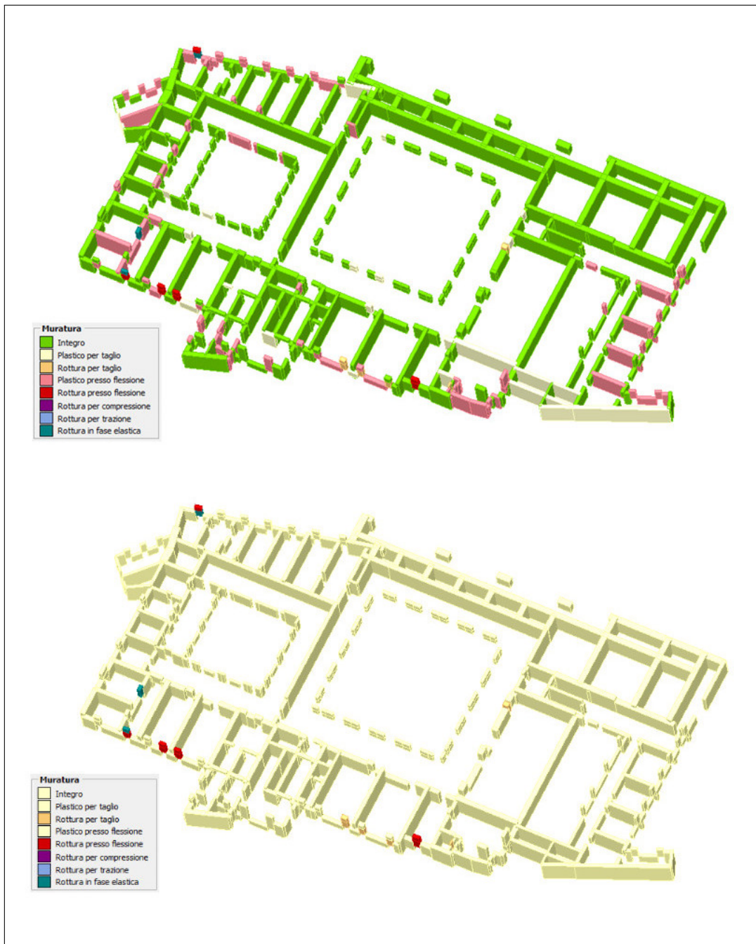
Figura 7.34: Analisi n.3. Piano primo: vista 3D del tipo di danno per sisma in direzione -X . Nell'immagine in alto sono visibili tutti gli elementi, colorati in base al danno; nell'immagine in basso sono più evidenti gli elementi rotti.
