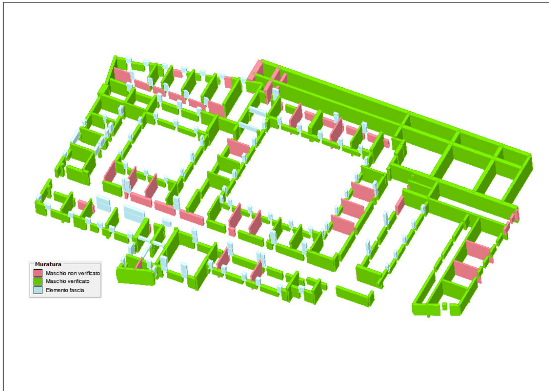
Figura 8.3: Verifiche statiche SLU maschi murari piano secondo.
