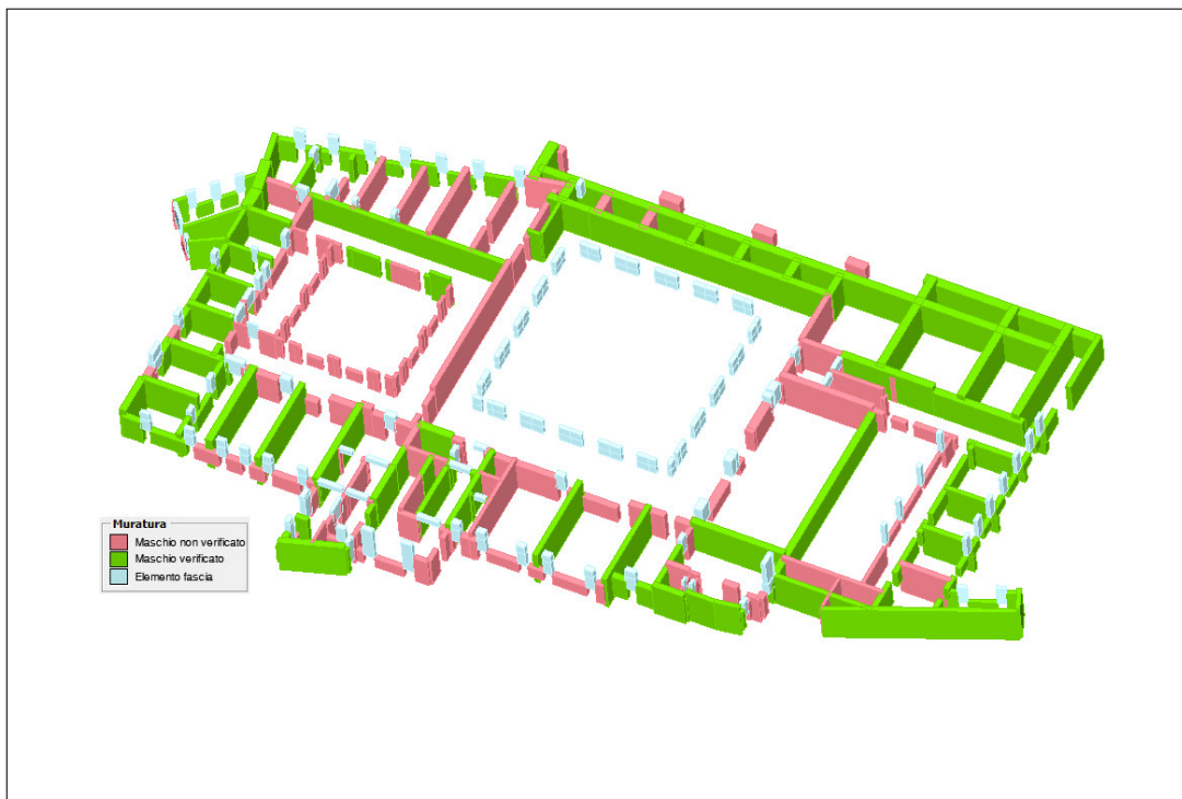
Figura 8.2: Verifiche statiche SLU maschi murari piano primo.
