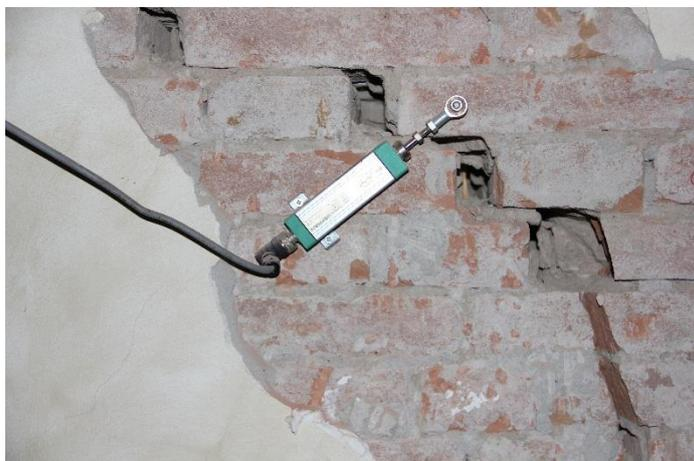
Figura 89 : Fessurimetro elettronico installato sulla crepa dello scalone interno
