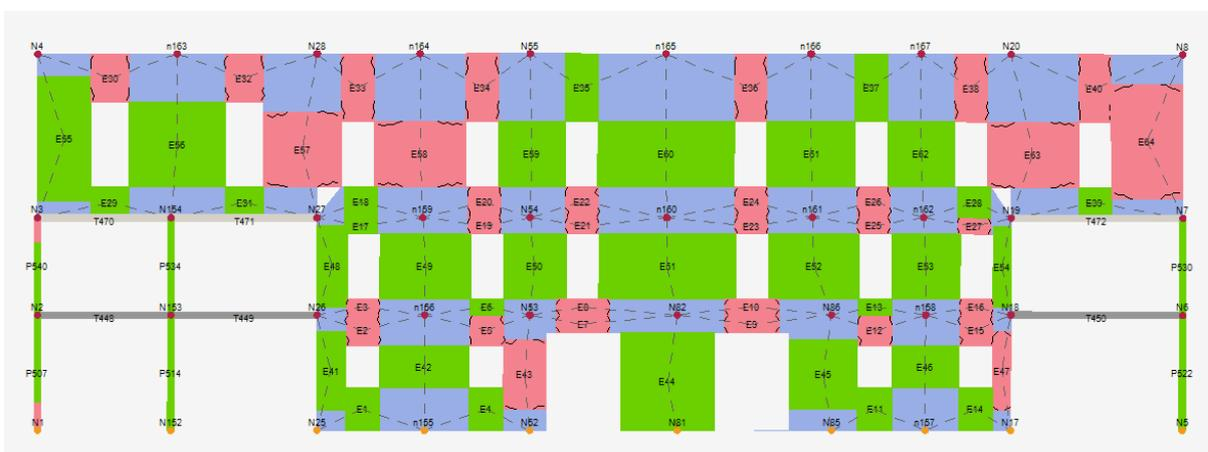
Figura 120 : Fessurazioni al termine della analisi sismica
